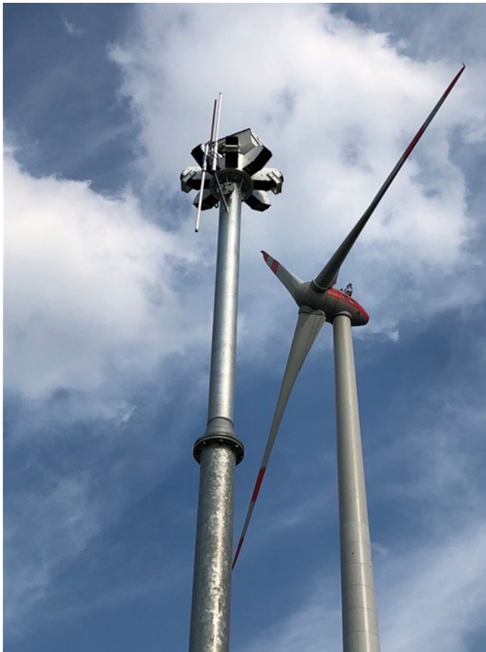
Abbildung 4: Kamerasystem (Identiflight) zum Schutz von Rotmilanen im Windpark Bütow (Foto: C. Dohm)
