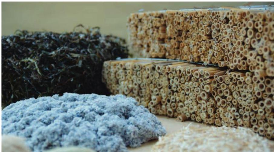
Abbildung 1: Eine Auswahl verschiedener Naturdämmstoffe<sup>1</sup>; Im Hintergrund v.l.n.r. Seegras, Zelluloseflocken und Schilfrohrplatten
